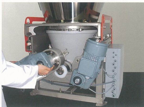
6. 復旧は、各部品を元の位置に取り付け、モータ・ギアボックスをスイングさせ、バックパネルを取り付けます。
