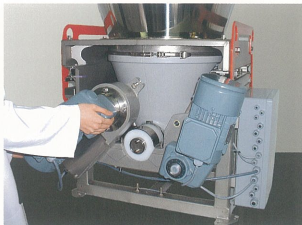
2. 固定ボルトを緩め、モータ・ギアボックスをスイングさせます。
