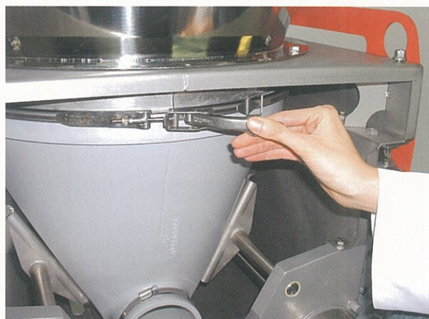
4. 拡張ホッパーとフレキシブルホッパー間のクランプのレバーを外します。
