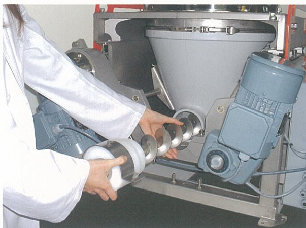
3. ホースバンドと、ナットを緩め、ドライブシャフト及びヘリックスを後ろ方向へ引き出します。
